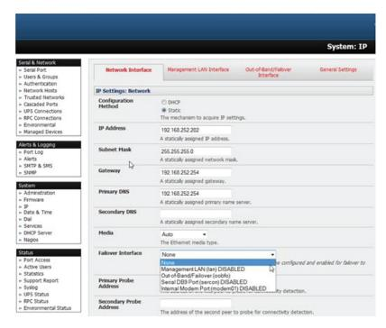
FIGURE 6-6. SYSTEM IP: NETWORK INTERFACE TAB
