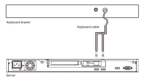
FIGURE 4. CONNECTING TO THE SERVER
